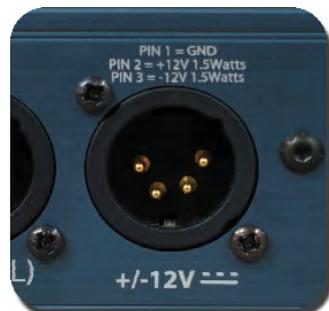
Signature系列产品支持4针XLR接口±12V DC直流电源，可以连接PS1电源基站，用作主电源或冗余电源
